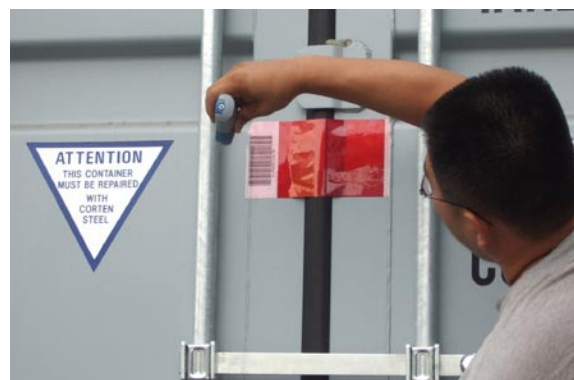
Lecteur de code-barres portable pour le contrôle d'identité des conteneurs
